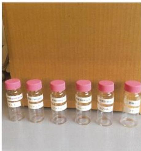
図6. 1000ppm 酢酸 0.2 mlにサンプル 0.02 mlを加えた検体
